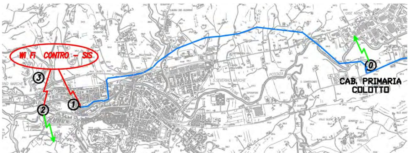
Figura 10. Architettura del sistema di comunicazione nell'area Ovest del Progetto (blu=fibra ottica; verde=reti mobile; rosso=Wi-Fi).
