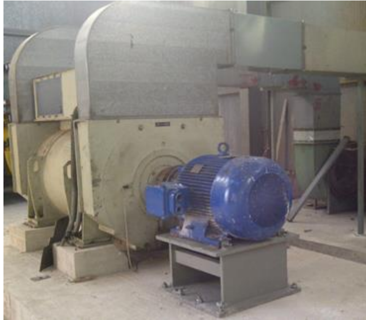
Figura 2.11 – Foto compensatore sincrono impianto pilota n°4
