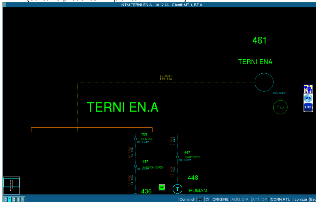
Figura 3.36 – Unifilare montante impianto pilota numero 1 (Terniena)
