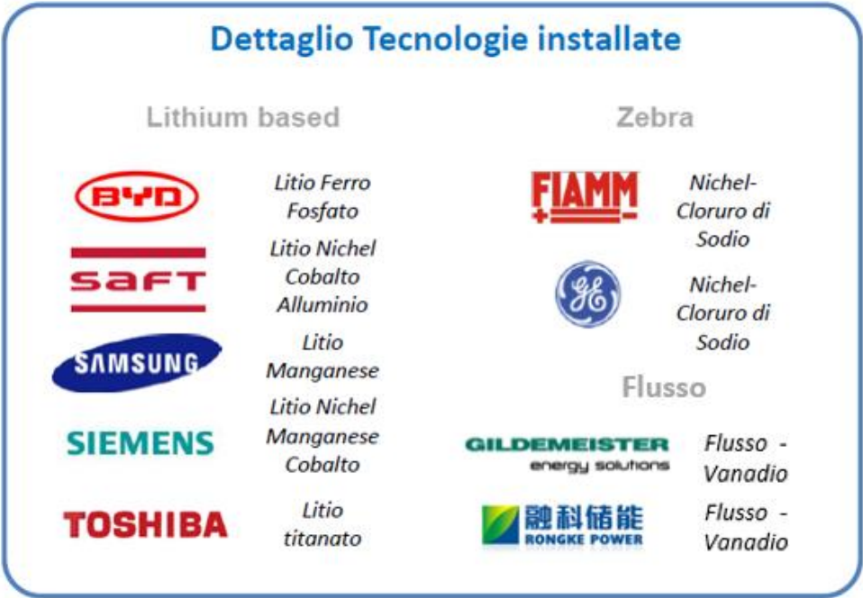
Figura 1 Fornitori delle tecnologie di batterie elettrochimiche installate al 31 Dicembre 2017
