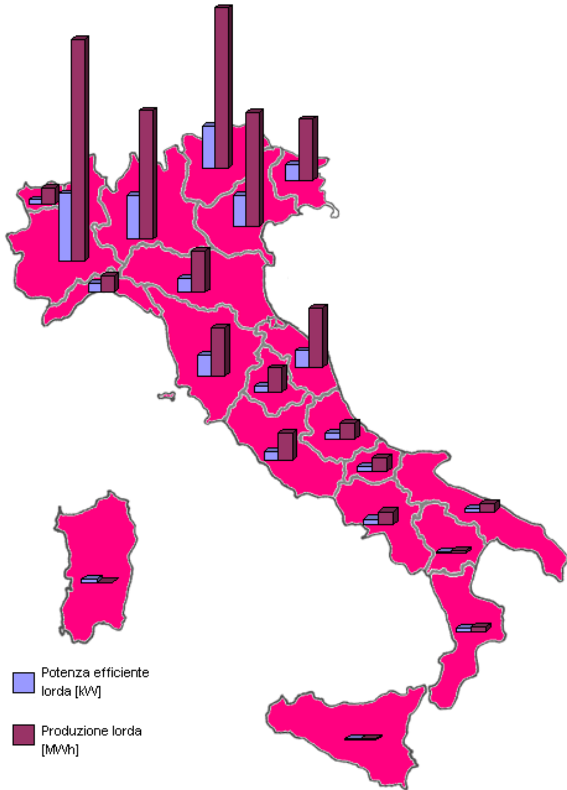
Figura 4.37: Dislocazione regionale degli impianti di PG (Potenza efficiente lorda totale: 586 MW; Produzione lorda totale: 1.871 GWh).
